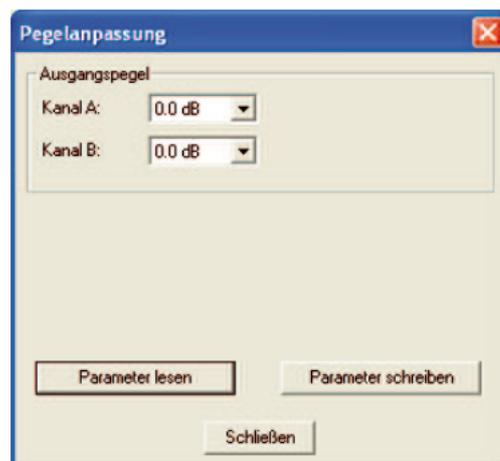
Durch den Button „Parameter lesen“ werden zunächst die aktuell eingespeicherten Werte aus der Karte gelesen. Durchgeführte Änderungen werden erst durch „Parameter schreiben“ in die Karte geschrieben und aktiviert.
