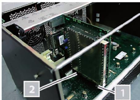
Bild 4a: Einbauzustand der Steckkarte (V 16 Basiseinheit)
