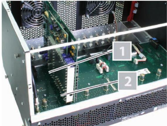
*Bild 4: Einbauzustand der Steckkarte (Beispiel: V 16 Basis)*
