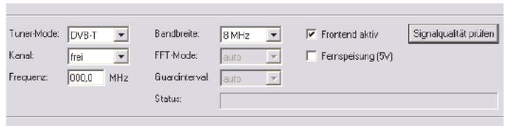
Bild 10: Eingangsparameter für den DVB-T Tuner
