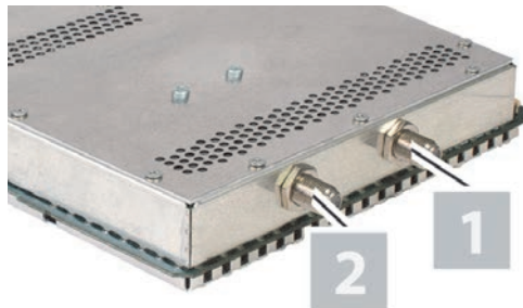
Bild 5: Tuner mit DVB-T/T2/C Signal verkabeln
