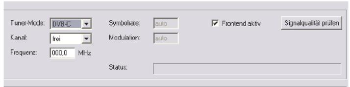
*Bild 9: Eingangsparmeter für den DVB-C Tuner*
