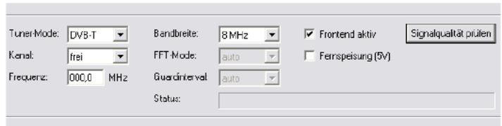
Bild 10: Eingangparameter für den DVB-T Tuner
