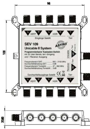
Zum Anschließen der Ein- und Ausgänge des Geräts verwenden Sie hochwertige Koaxialkabel mit F-Steckern, die für den Satellitenempfang vorgesehen sind. Verwenden Sie hoch geschirmte Koaxialkabel mit einer Mindestabschirmung von 90 dB. Wenn Wandsteckdosen zum Durchschleifen des Unicable II-Ausgangs verwendet werden sollen, stellen Sie sicher, dass diese für den Satellitenempfang konzipiert, mit Unicable-Technologie kompatibel sind und eine bidirektionale Signalübertragung ermöglichen.
