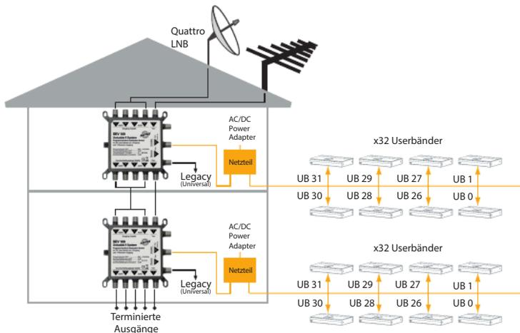
Schließen Sie die Kabel vom Quattro-LNB an den Eingangsanschlüssen an, die mit LNB V/L, V/H, H/L und H/H gekennzeichnet sind (achten Sie auf die richtige Bezeichnung der Quattro-LNB-Anschlüsse). Der Multischalter ist mit einem terrestrischen Eingang ausgerüstet. Schließen Sie die terrestrische Antenne an diesem Eingang an:
