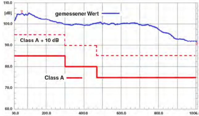
EMV Messung am neuen GUT-Anschlussdosenchassis
