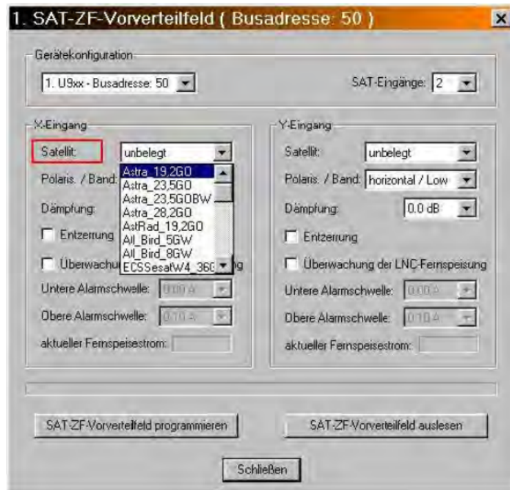
Bild 4: SAT-ZF-Vorverteilerfeld, Eingänge belegen
