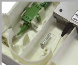
4. Verbinden Sie nun die HF Ausgangsbuchse des Nodes mit dem F-Stecker eines HF Kabels. Dazu müssen Sie das HF Kabel zunächst durch die dafür vorgesehene Aussparung im mittleren Kunststoffgehäuseteil führen (siehe links).
