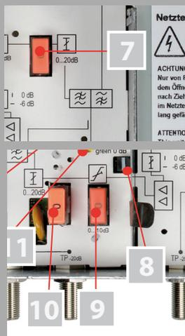
4. Stellen Sie den Dämpfungssteller [10] hinter dem Rückwegverstärker durch Stecken des entsprechenden Pads ein, um die Dämpfung im nachfolgenden Netz anzugleichen.
