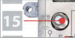
Am Eingang ist eine bidirektionale Testbuchse [15] mit 20 dB Auskoppeldämpfung vorhanden. Hiermit können Sie:
