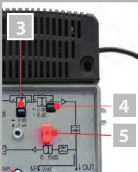
3. Zwischen den Verstärkerstufen (Interstage) können Sie eine Vorentzerrung (0 oder 7 dB Slope) der abgehenden Kabel­länge einstellen, indem Sie die Steckbrücke [3] entsprechend umstecken. Beachten Sie dabei auch hier die Beschriftung neben der Steckbrücke.
