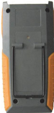
Das Akkufach befindet sich auf der Rückseite des Geräts und kann geöffnet werden, indem Sie den schwarzen Bügel nach oben klappen. Legen Sie zwei wieder aufladbare Akkus des Typs AA ein und rasten Sie den Bügel wieder ein.
