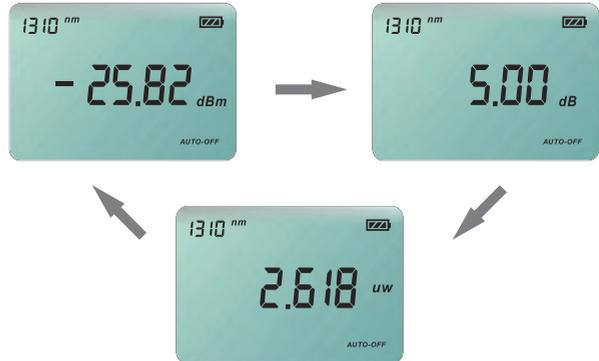
**HINWEIS:** „dB“ und „mW“ sind die Einheiten, die den absoluten Wert des gemessenen Leistungswerts darstellen. Wenn dieser Leistungswert in der Einheit „mW“ weniger als 1 mW beträgt, wird die Einheit automatisch auf „uW“ umgestellt.
