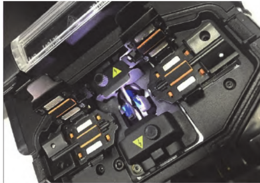
Abbildung 10: Einlegen der Faser in das Spleißgerät
