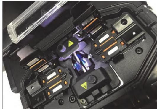
Abbildung 10: Einlegen der Faser in das Spleißgerät
