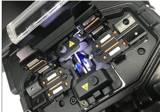
Abbildung 16: Einlegen der Faser in das Spleißgerät
