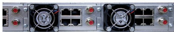
Rückansicht U 100 mit Netzwerkschnittstellen, Ausgängen und temperaturgesteuerten Lüftern
